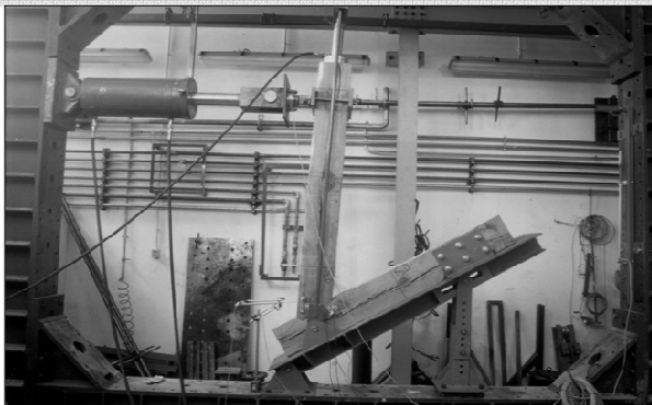
Nodi provati con angoli di 30-60-90° - Rinforzi: nessuno, bullone/i, fascia, reggia
