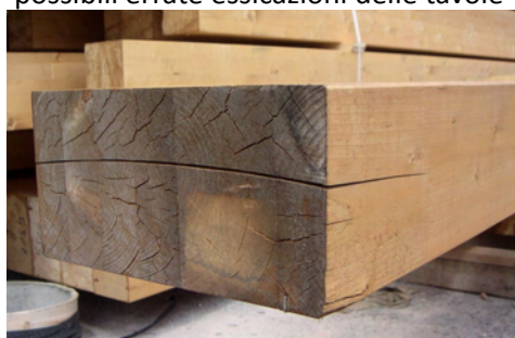
Lamellare fessurato anche per possibili errate essiccazioni delle tavole
