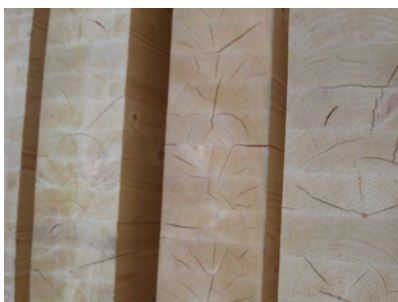
Lamellare fessurato anche per possibili errate essiccazioni delle tavole
