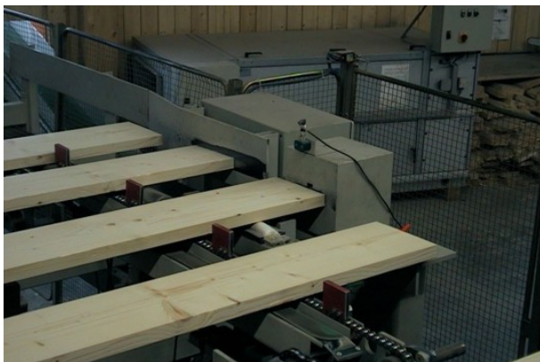
Figura 18: Impulso e misura della frequenza – Dimter Grademaster 403
