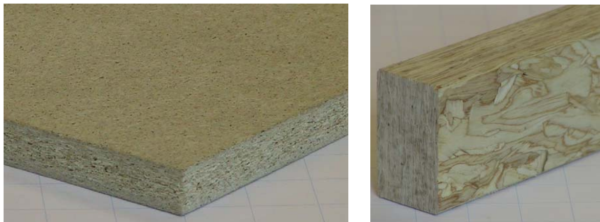
Figura 20: Pannello piano pressato incollato con resine sintetiche (sin.) e pannello di trucioli a striatura (des.)
