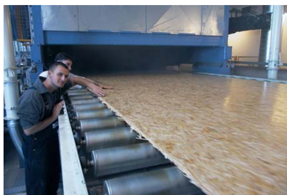
Pannello „ininterrotto“ sui rulli della pressa
