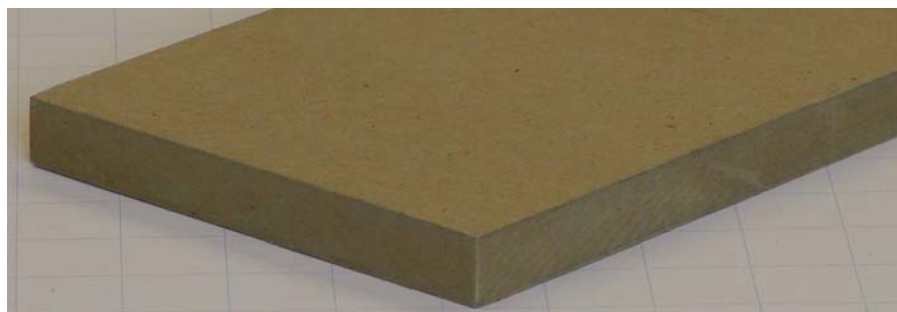
Figura 17: Pannello di fibra di legno a media densità (MDF)
