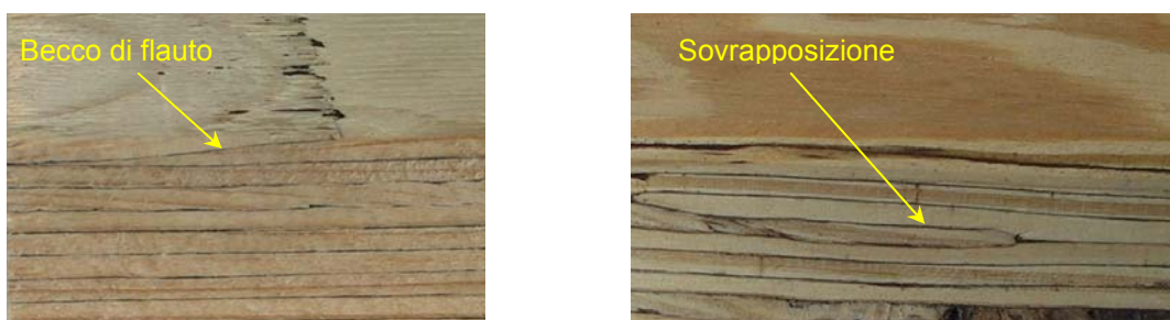
Figura 29: Allungamento dei singoli piallacci mediante giunto a becco di flauto (sin.) o mediante sovrapposizione (des.)
