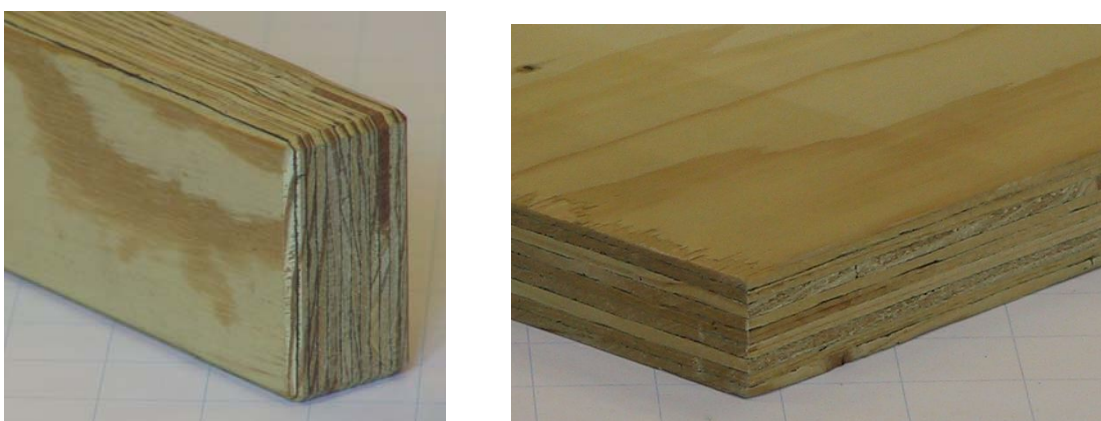
Figura 27: Pannello di piallaccio stratificato (sin.) e pannello compensato (des., i singoli strati del pannello sono composti da alcuni strati di piallaccio con fibre parallele)
