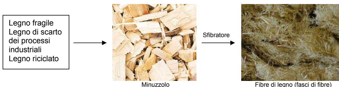
Figura 12: Fasi produttive delle fibre di legno
