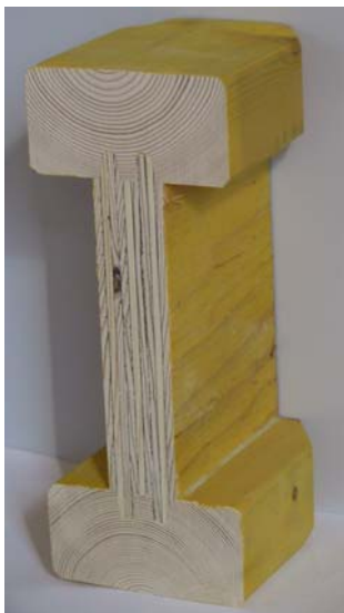
Figura 31: Anima della trave a I di piallaccio compensato
