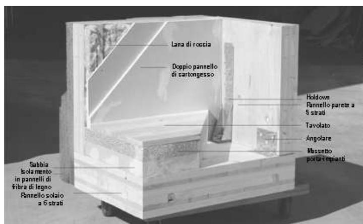
Figura 8: Pacchetti costruttivi per parete e solaio.
