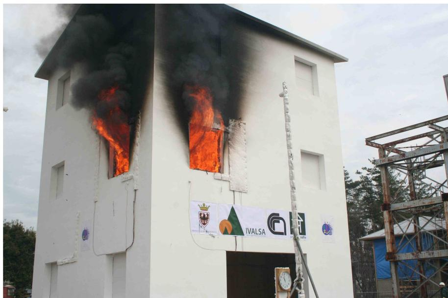
Figura 11: Un momento della prova durante la fase di incendio pienamente sviluppato (fonte [www.progettosofie.it](http://www.progettosofie.it)).
