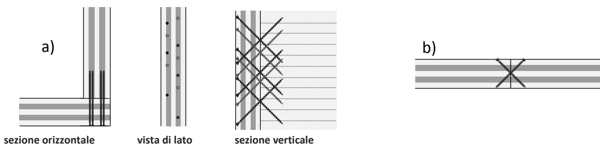
Figura 41: collegamento d'angolo e nel piano con viti a tutto filetto inclinate
