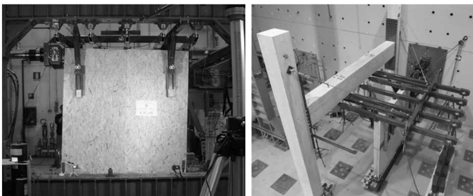
UniTN. Set-up di prova per pareti portanti in legno sottoposte ad azione orizzontale ciclica, con differenti dimensioni, carichi verticali, condizioni di vincolo a terra.
