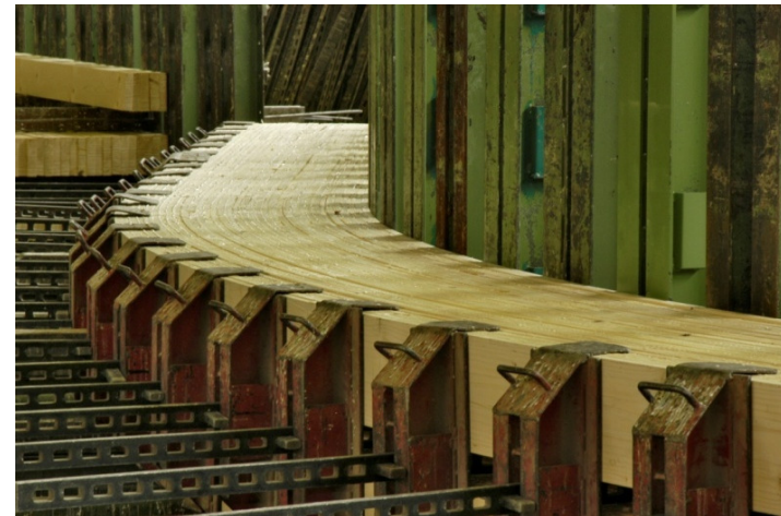
Letti di pressaggio per elementi in legno lamellare
