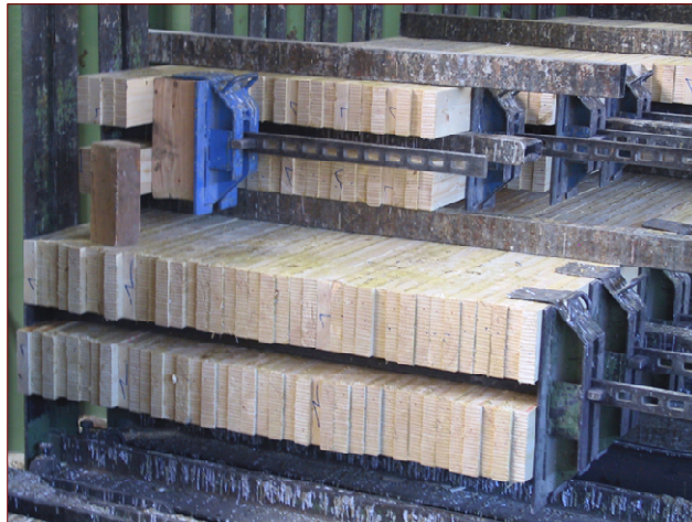
Letti di pressaggio per elementi in legno lamellare
