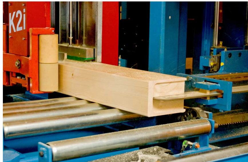
Taglio del materiale con macchine a controllo numerico
