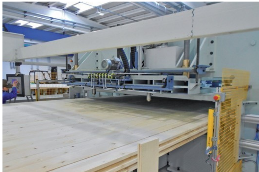
Presse idrauliche o sottovuoto per pannelli xlam
