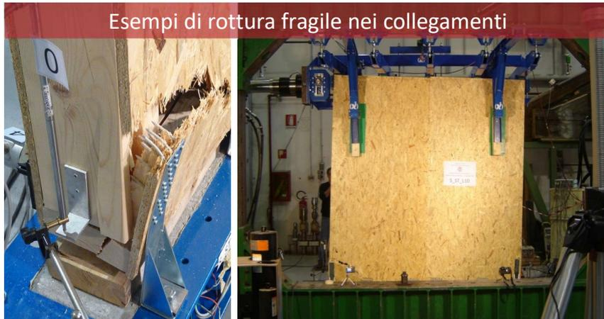
Esempi di rottura fragile nei collegamenti
