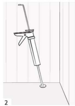
2 Iniezione dell'ancorante chimico nel foro
