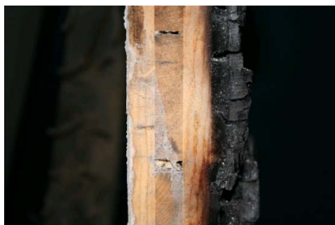
Figura 4: Pannello a strati incrociati da 85 mm sottoposto a prova di incendio su forno verticale della durata di 60 min nel 2007 presso il laboratorio di prove al fuoco del CNR-IVALSA a San Michele all'Adige diretto dalla Dott.ssa Giovanna Bochicchio. Nella foto la sezione del pannello al termine della prova; il pannello è formato da 5 strati ognuno di 17 mm, come si nota al termine della prova sono rimasti 3 strati praticamente intatti, pertanto si è avuta una carbonizzazione di 35-40 mm. Nel grafico a destra la variazione di temperatura durante la prova sulla superficie non esposta; mentre sulla faccia esposta al fuoco le temperature sono arrivate quasi a 1000 °C; sulla faccia non esposta si è avuto un aumento di temperatura di soli 7 °C.
