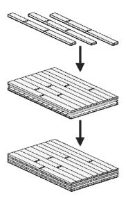
Figura 8: Produzione del pannello XLAM in una unica fase di produzione
