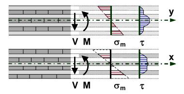
Figura 14: Distribuzione delle tensioni di flessione e di taglio sulla sezione per i due casi
