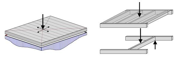
Figura 16: Differente comportamento strutturale fra la piastra XLAM e un solaio con travatura inflessa
