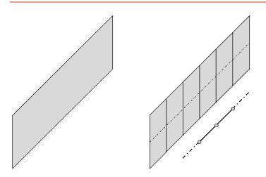
Figura 24: parete intera o parete formata da più elementi con giunti verticali
