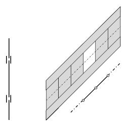
Figura 25: Lastra verticale composta da più elementi con giunti orizzontali rigidi
