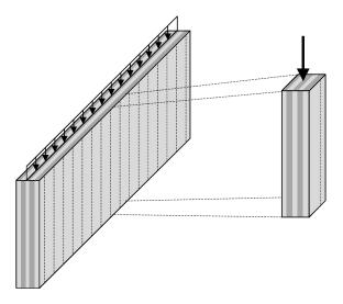
Figura 17: Elemento di parete con funzione di discesa dei carichi verticali
