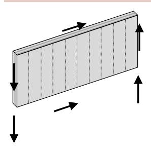
Figura 17: Elemento di parete con funzione controventatura (forze orizzontali nel piano della parete)
