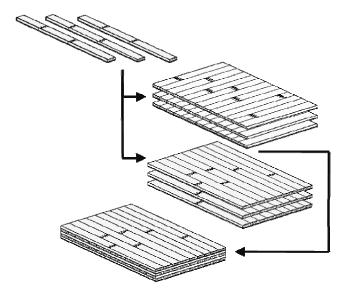
Figura 9: Produzione del pannello XLAM in due distinte fasi di produzione
