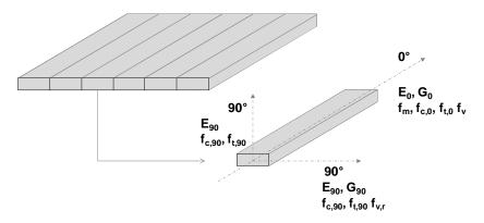
Figura 11: Caratteristiche meccaniche (profilo prestazionale) di uno strato di tavole
