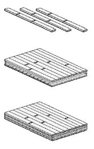
Figura 6: Principio della composizione dell'XLAM
