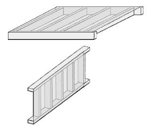
Figura 1: Elementi di solaio e di parete della costruzione intelaiata
