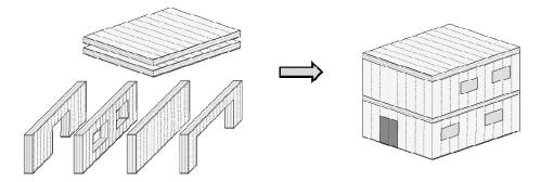
Figura 18: Struttura portante dell'edificio formata da elementi piani
