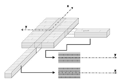
Figura 13: XLAM quale griglia di elementi lineari e multistrato
