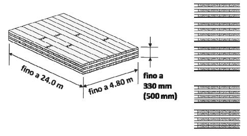
Figura 10: Dimensioni massime e esempi della composizione della stratigrafia dei pannelli XLAM
