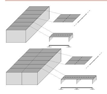
Figura 19: Principio strutturale e giunti della soletta XLAM
