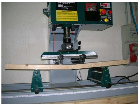
Figura 3; 4 – Prove di rottura sul giunto e delaminazione eseguite in stabilimento
