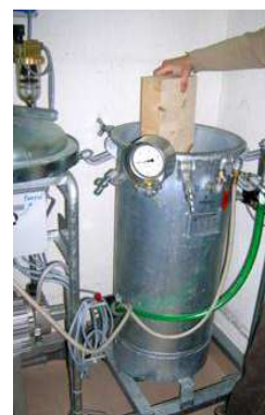
Figura 3; 4 – Prove di rottura sul giunto e delaminazione eseguite in stabilimento
